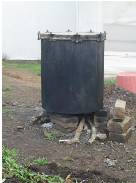
Figura 7. Desinfección de sustrato por calor en caldera.
